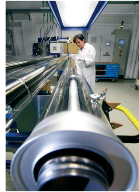
Receiver für Parabolrinnenkollektor; Quelle: Schott AG
