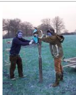
Christopher Poeplau (l.) und Marc Jantz bei der Bodenprobenahme mit Rammkernsonde in Trenthorst (Schleswig-Holstein) (© vTI/AK)
