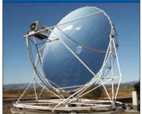
Abb. 5: Der „EuroDish“ (8,5 m Durchmesser)
